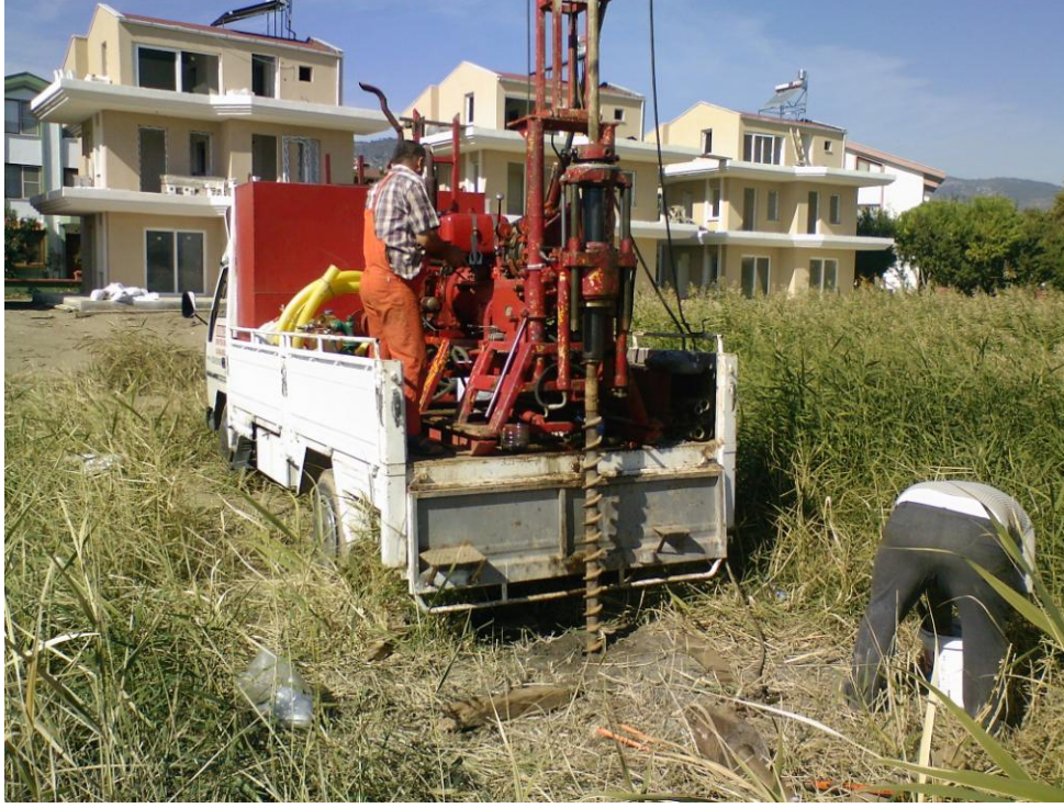
Şekil 7. Arazide SPT deneyine ait sondaj çalışması
