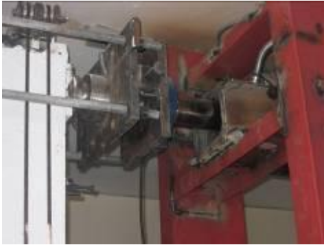
Şekil 13 Deneysel kullanılan yatay yük ölçüm düzeneği
