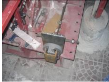
Şekil 14 Deneysel kullanılan düşey yük ölçüm düzeneği
