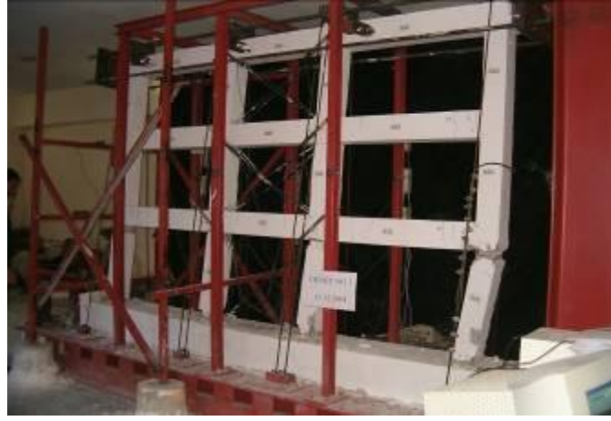
Şekil 24 3 nolu deney numunesinin deney sonundaki görünüşü
