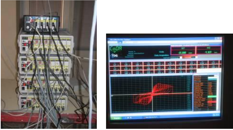
Şekil 16 Yük ve yer değiştirme okumalarını değerlendiren veri aktarım sistemi ve bilgisayar düzeneği
