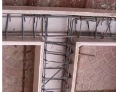
Şekil 6 T2 donatı düzenine sahip numunede etriyesiz kolon kiriş birleşim bölgesi
