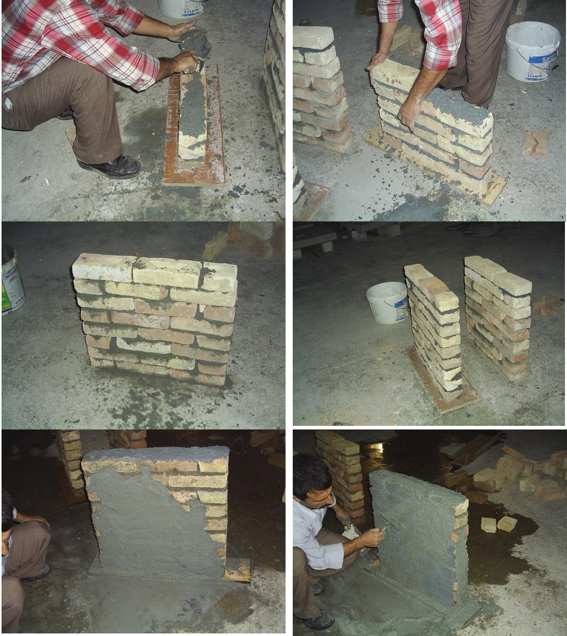
Şekil 4. Deney numunelerinin hazırlanması
