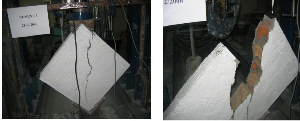
Şekil 7. 3 nolu deney numunesinin deney esnasında ve deneyden sonraki görüntüsü
