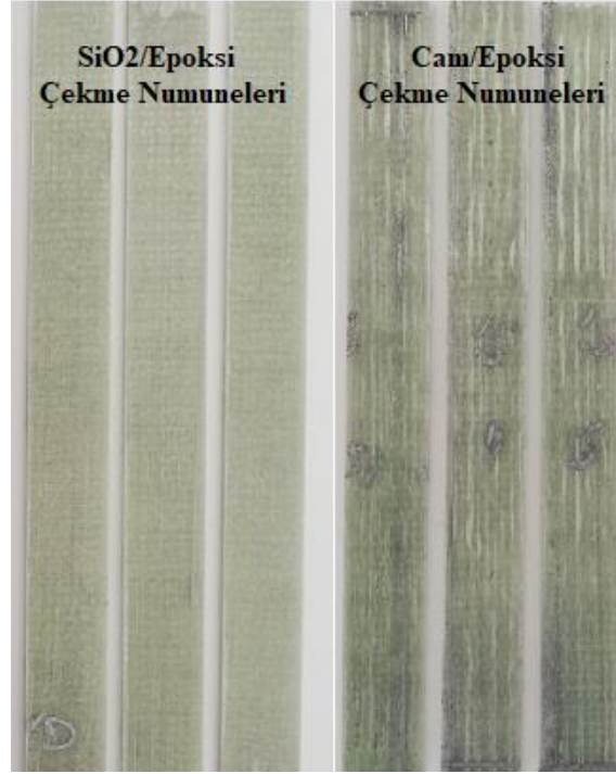
řekil 1. Nanosilika katkılı ve katkısız Cam/Epoksi çekme test numuneleri [12]
