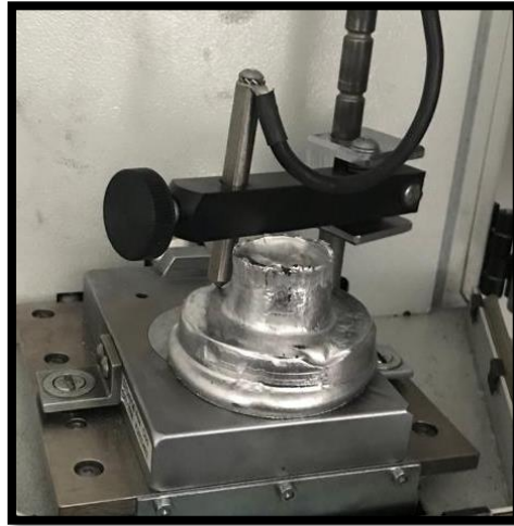
Şekil 6. Spektral analizi yapılan nano katkılı alüminyum
