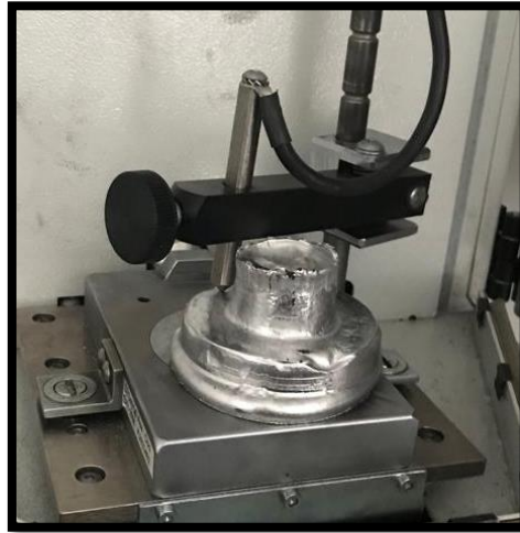
Şekil 6. Spektral analizi yapılan nano katkılı alüminyum
