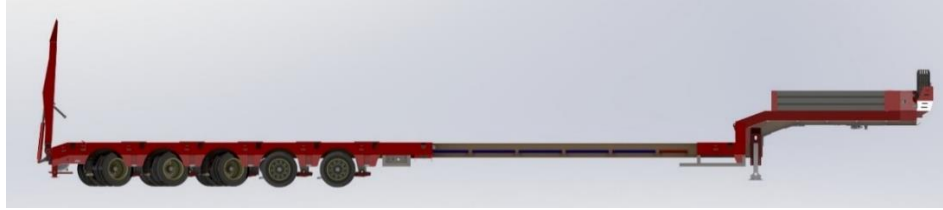
Şekil 5. Teleskopik şase 6 sıra akslı düşük yataklı yarı römork
