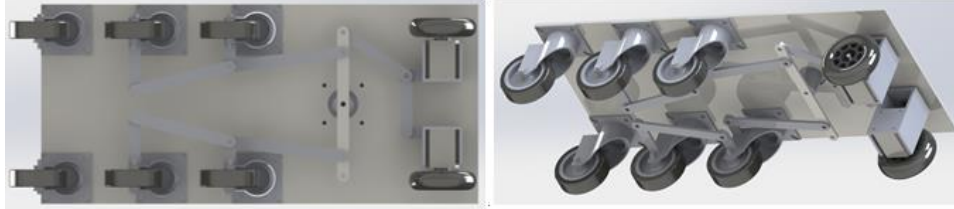
Şekil 9. Ackermann modeline göre modellenen mekanik alt düzel ve genel montaj
