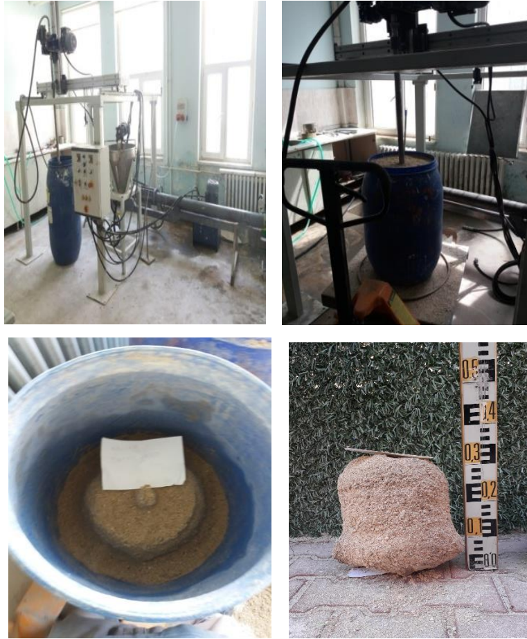
Şekil 3. Kullanılan jet grout deney düzeneği ve kolon oluşum aşaması
