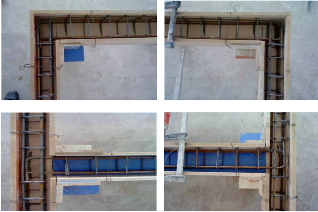
Şekil 3. Numunelerin üretiminde uygulanan hatalar
