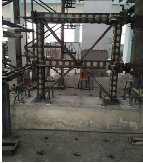
Şekil 5. KL3 numunesine uygulanan güçlendirme tekniği
