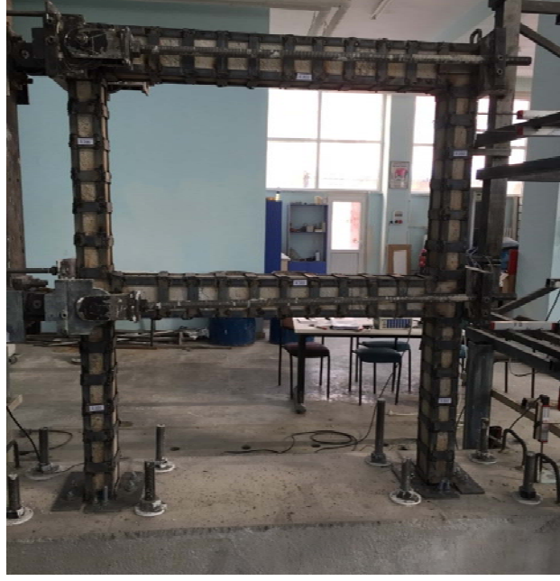
Şekil 4. KL2 numunesinde kullanılan güçlendirme tekniği
