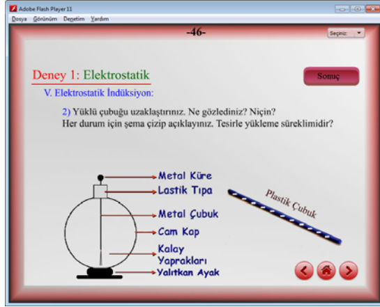
(a) (b) Şekil 21. Elektroskopun etki ile yüklenmesi
