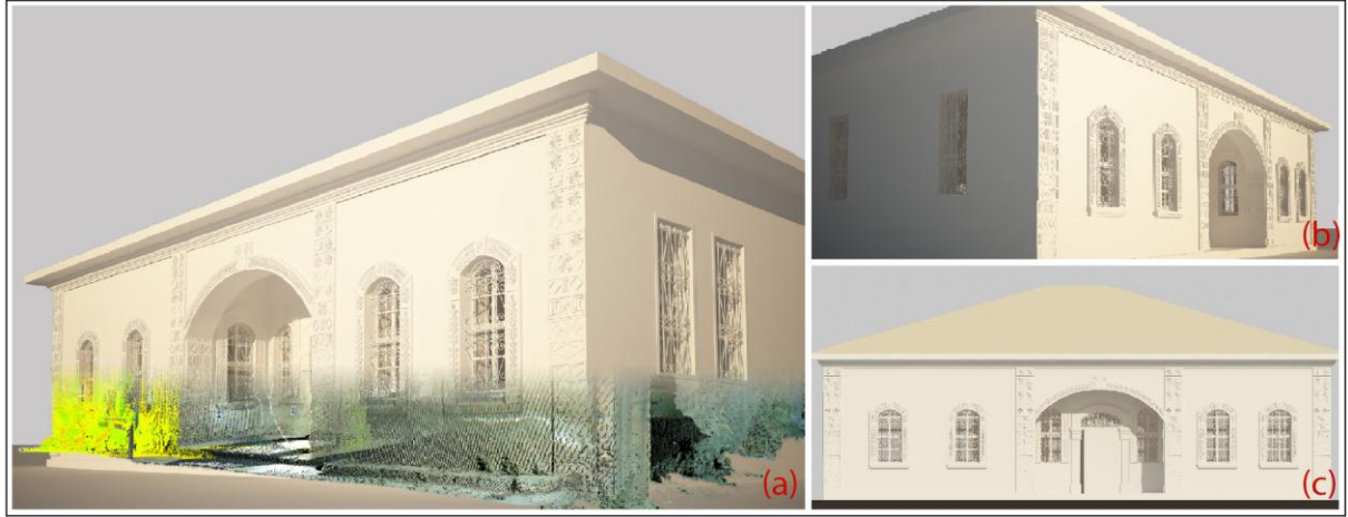
Şekil 7. (a) 3D model ve nokta bulutu veri. (b) AutoCad'ten 3d Studio Max'e aktarılan 3D model (c): Renderlı ön cephe
