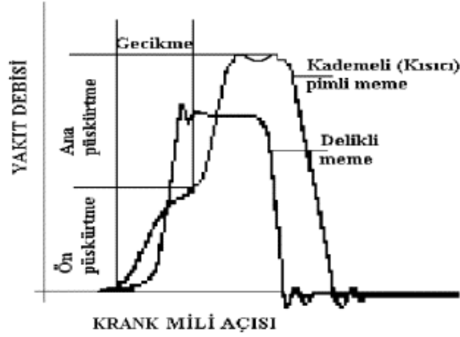
Şekil 2 Krank Mili Açısına Bağlı Olarak Püskürtülen Yakıt Debisi (16).
