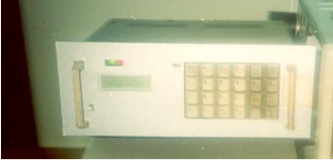
Şekil 5. Gerçekleştirilen Mikrobilgisayarın Ön Görünüşü
