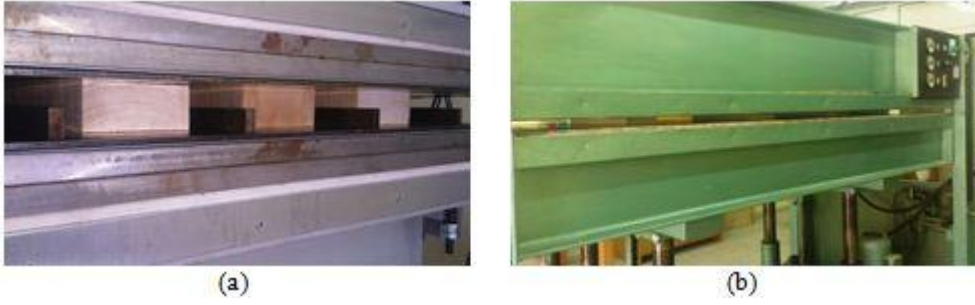
Şekil 1. Örneklerin yoğunlaştırılması (a), yoğunlaştırılan örneklerin soğutulması (b)
