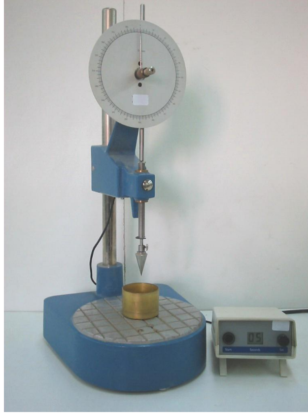
Şekil 1. Deneysel olarak kullanılan koni batma likit limit aleti.
