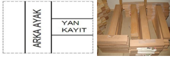
Şekil 1. Sandalye birleştirmelerini temsil eden T-tipi elemanlar
