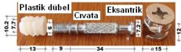
Şekil 2. Eksantrik çektirme (minifiks) elemanları ve ölçüleri (mm)
