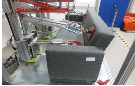
Şekil 7. Kanepenin oturma yeri ve arkalık yorulma deneyi [15]
