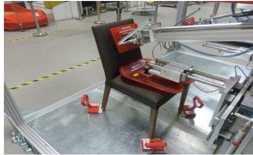
Şekil 8. Sandalyenin oturma yeri ve arkalık yorulma deneyi [15]
