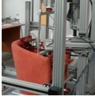
Şekil 6. Oturma/arkalık statik yük deneyi [14]
