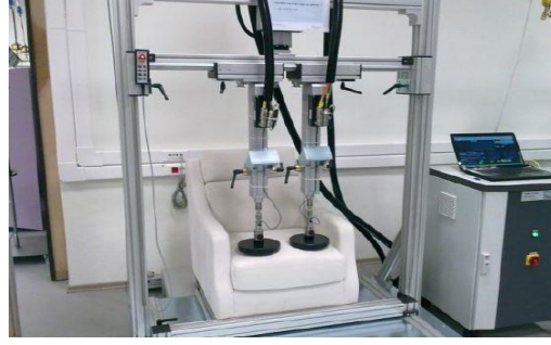
Şekil 9. Oturma Yeri ön kenarı yorulma deneyi [15]
