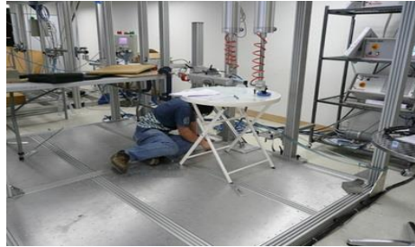
Şekil 13. Masa düşey yük deneyi [14]
