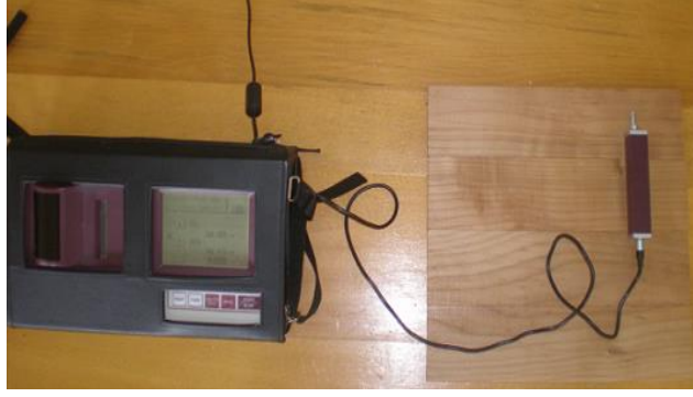
Şekil 1. Mitutoyo SurfTest SJ-301 ile yüzey pürüzlülüğü ölçülmesi [12].
