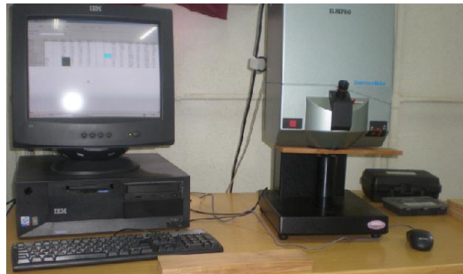
Şekil 3. Elrepho 71 cihazı ile renk değerlerinin belirlenmesi [12].
