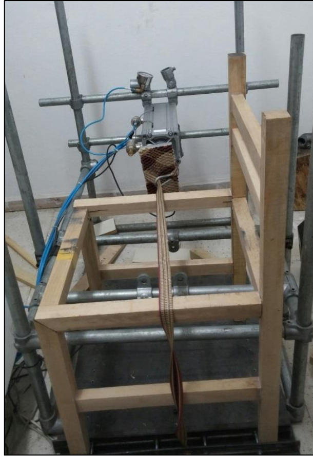
Şekil 6- Yan yorma yüklemesi test düzeneđi
