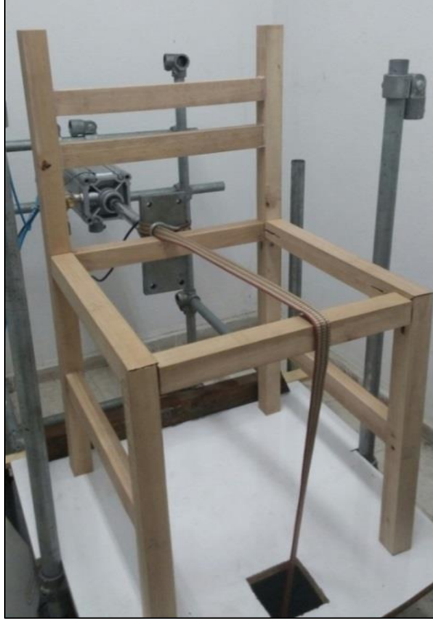
Şekil 5- Önden arkaya yorma yüklemesi test düzeneği.
