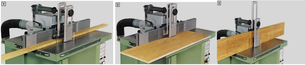
Şekil 11. Freze makinesinde siper, toz emme sistemi ve baskı donanımının kullanımı[27].
