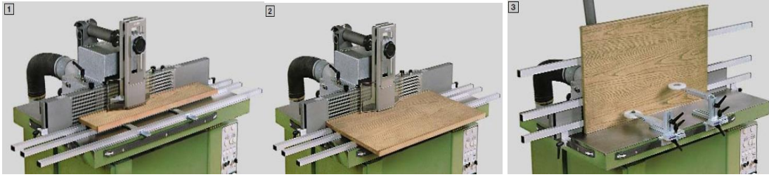
Şekil 10. Freze makinesinde kavisli parça işlemede ek tabla, siper ve robot kullanımı[27].
