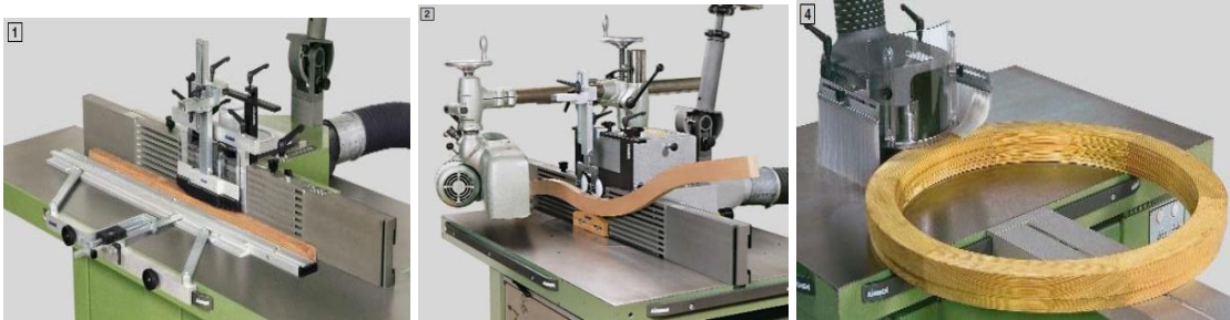
Şekil 14. Freze'de kavisli parça işlemede ek tabla, sper ve robot kullanımı[27].
