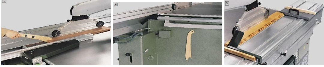
Şekil 20. Yatay Daire Testere makinesi kalıp-sper ve güvenlik donanımı[27].
