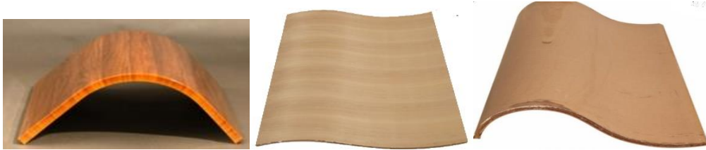
Şekil 11. CNC'de üretilemeyen kavisli ve bombeli yat mobilya parçaları
