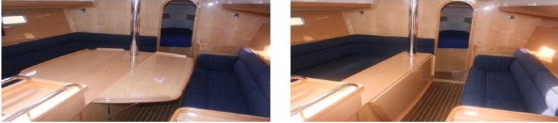
Şekil 5. Geçişi sağlamak için katlanan masa uygulaması [30].
