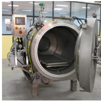
Şekil 4. PLC kontrollü, direkt soğutma metodu ile çalışan kriyojenik işlem sistemi
