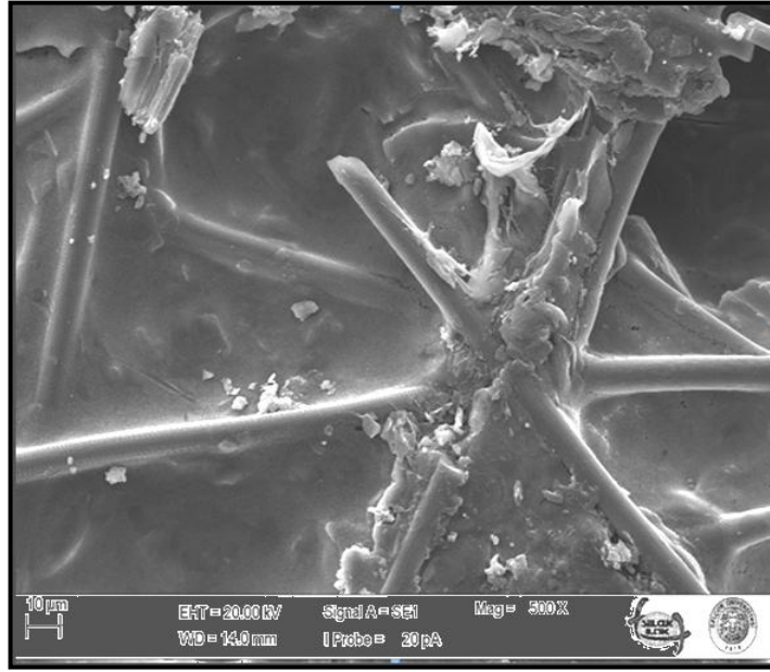
Şekil 11. YSZ+SDC+NaCaNiBO ile kaplanmadan önceki membranın 10 \mu\text{m} ’deki SEM görüntüsü
